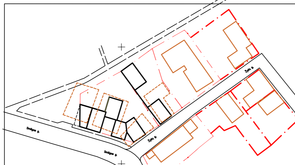
PROJEKTUOJAMŲ IR ESAMŲ PASTATŲ ŽYDŲ GATVĖJE URBANISTINĖ SCHEMA Suformuoti Žydų 1 ir Žydų 3 sklypai nesutampa su istoriškai susiformavusių sklypų ribomis. Pastatai projektuojami reaguojant į esamų sklypų ribas, išlaikant Žydų ir Smilgų gatvėms būdingą pastatų orientaciją ir dislokaciją sklype: galiniai fasadai orientuoti į gatvę, statomi prie sklypo ribos.
