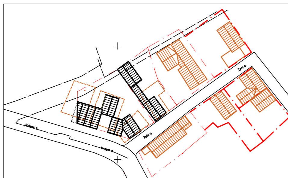
PROJEKTUOJAMŲ IR ESAMŲ PASTATŲ SKLYPUOSE ŽYDŲ GATVĖJE SCHEMA SU ŠLAITINIAIS STOGAIS Projektuojamų pastatų tūriai ir dislokacija sklype artima istoriškai susiformavusiam Žydų ir Smilgų gatvės užstatymui.
