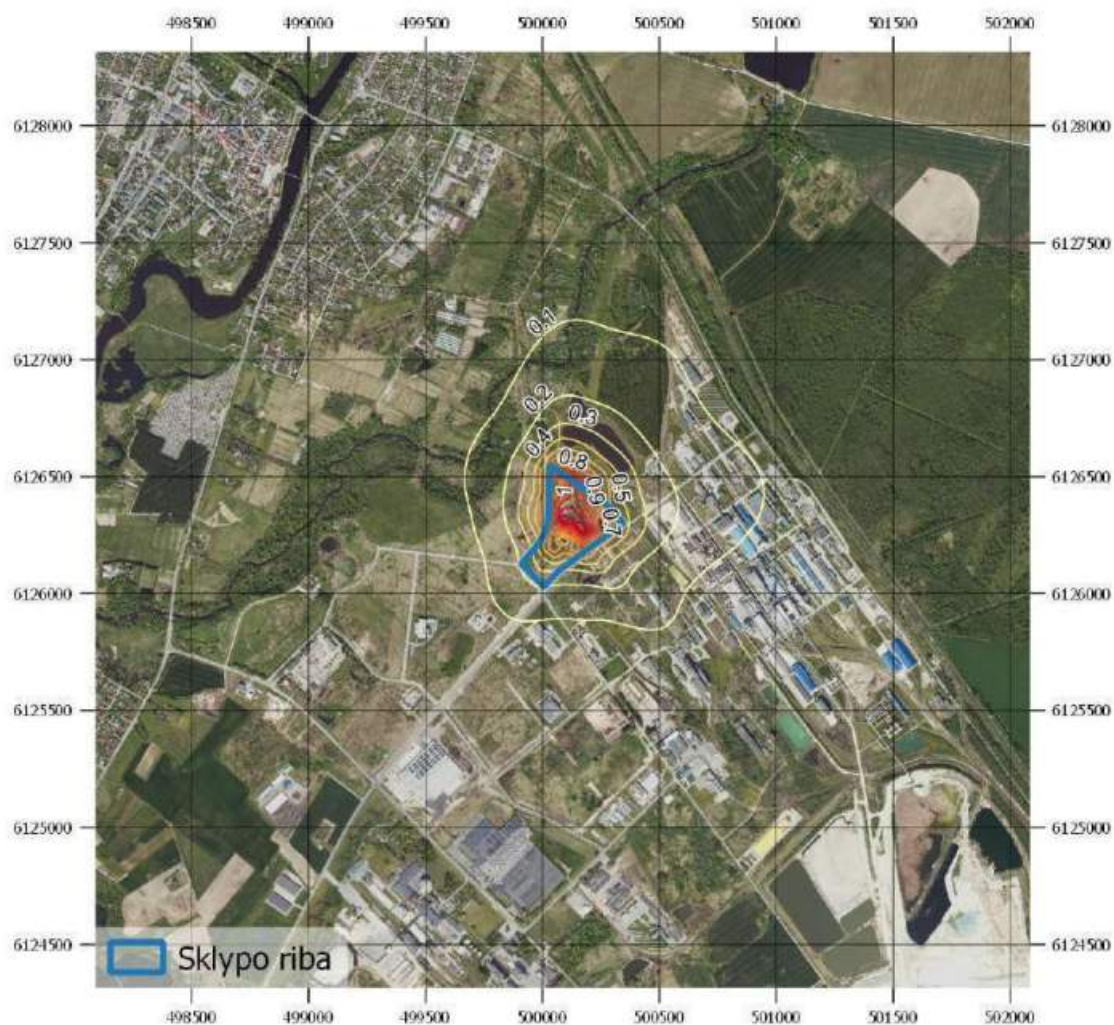
8 pav. Sumodeliuotų pažemio koncentracijų sklaidos žemėlapis (2,0 km spindulys). Kietųjų dalelių KD 10 metų vidutinė koncentracija (µg/m 3 ).
