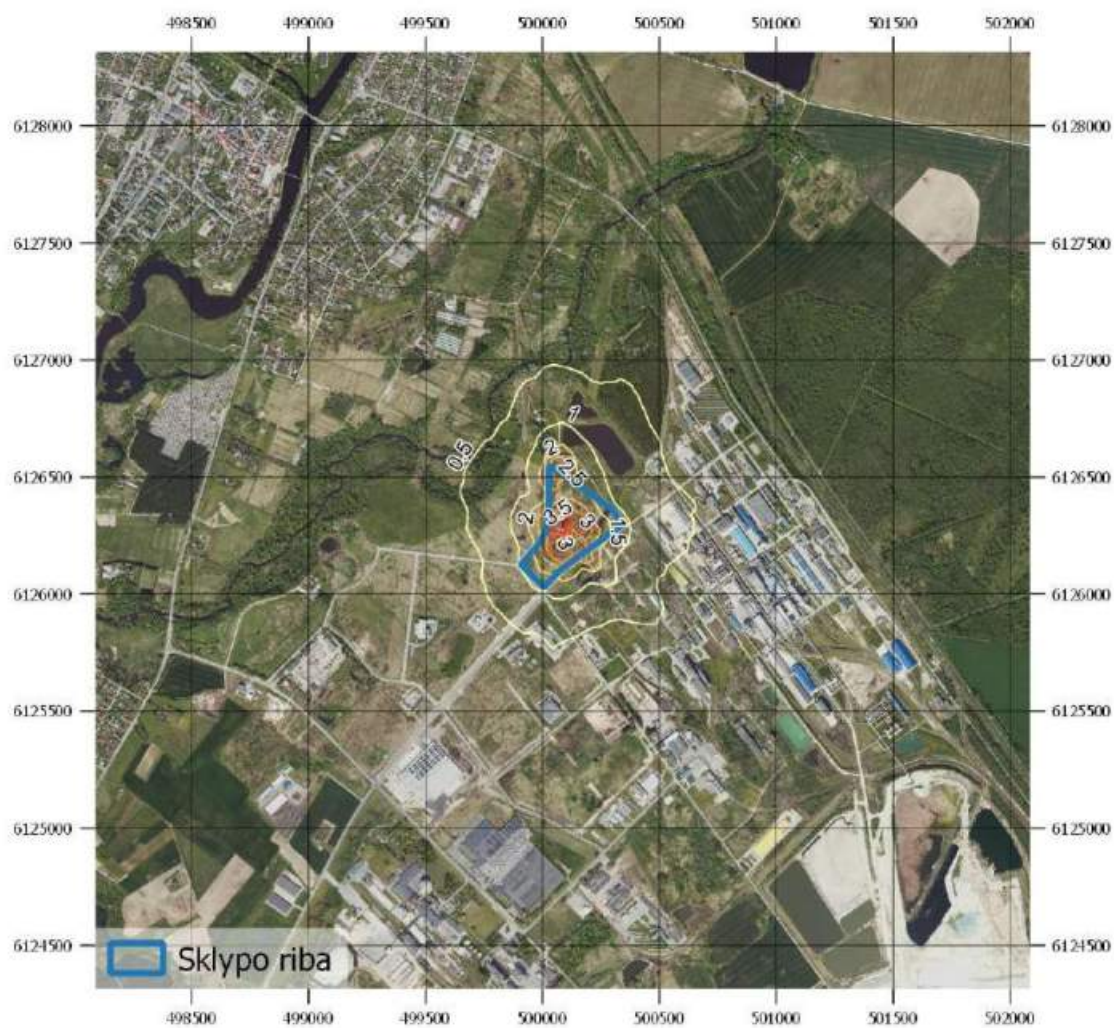
14 pav. Sumodeliuotų pažemio koncentracijų sklaidos žemėlapis (2,0 km spindulys). Kietųjų dalelių KD_{2,5} 24 valandų 99,2-o procentilio koncentracija ( \mu\text{g}/\text{m}^3 ).
