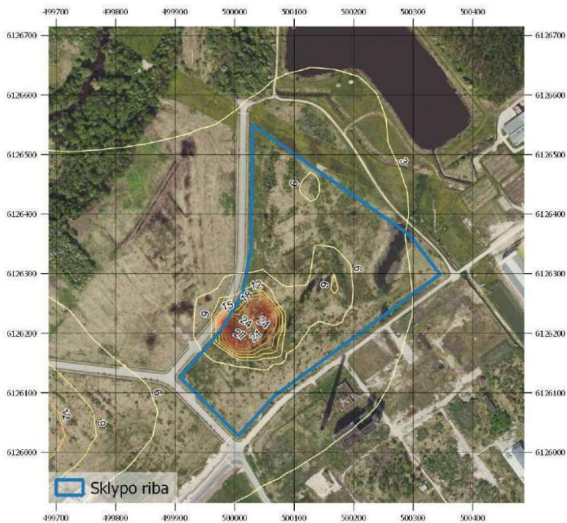
39 pav. Sumodeliuotų pažemio koncentracijų sklaidos žemėlapis (0,4 km spindulys). Lakiųjų organinių junginių valandos 98,5-o procentilio koncentracija ( \mu\text{g}/\text{m}^3 ).
