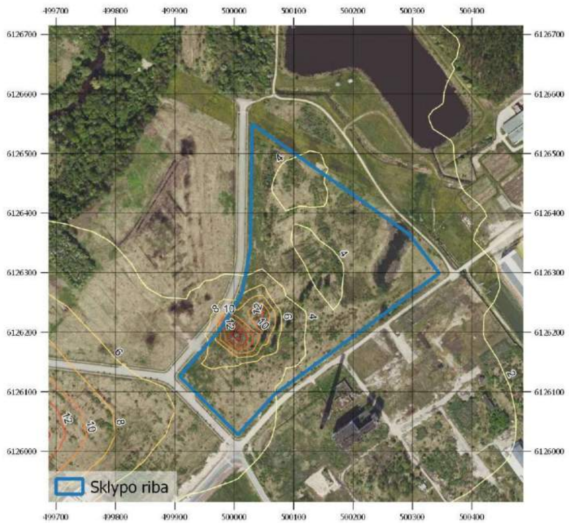
37 pav. Sumodeliuotų pažemio koncentracijų sklaidos žemėlapis (0,4 km spindulys). Lakiųjų organinių junginių 24 valandų vidurkio 100-ojo procentilio koncentracija ( \mu\text{g}/\text{m}^3 ).
