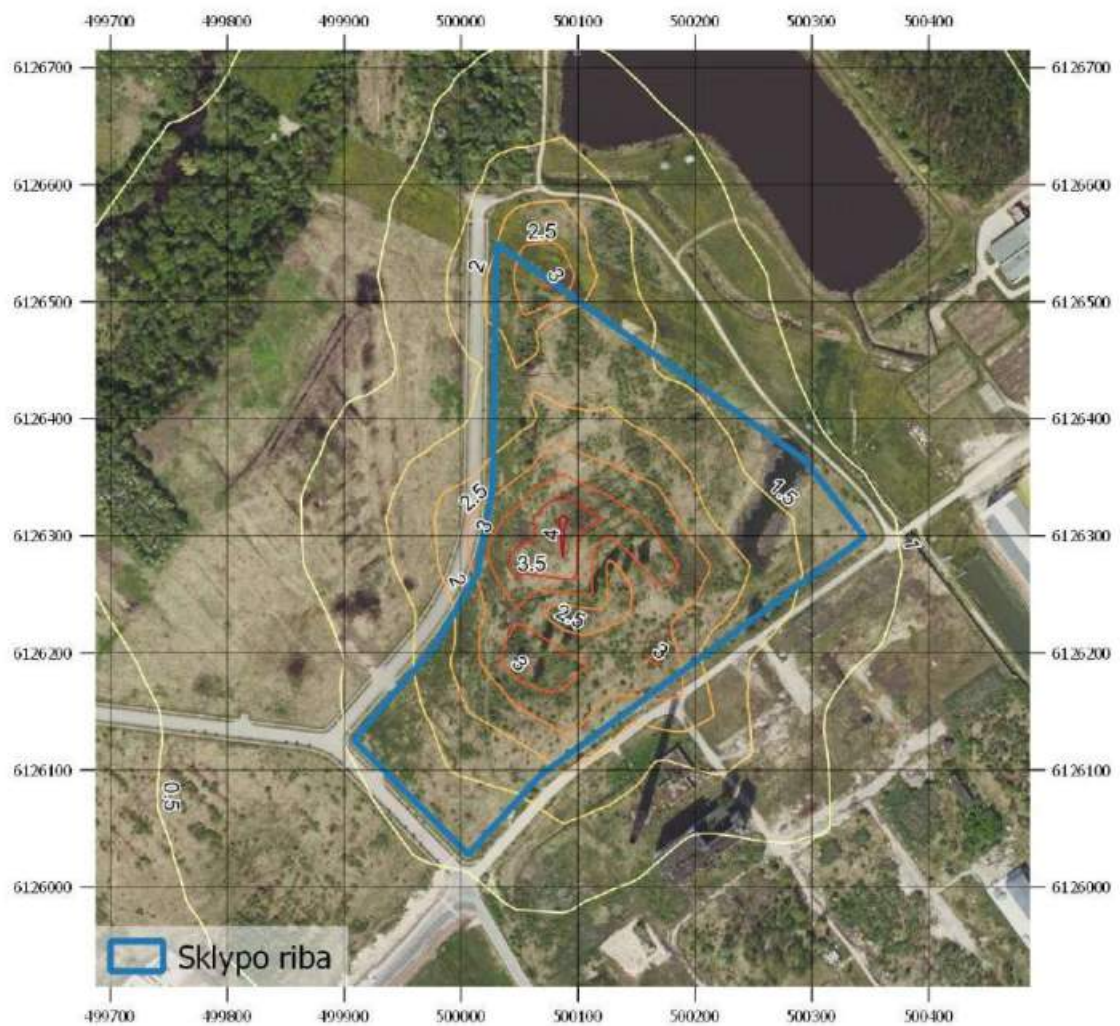
15 pav. Sumodeliuotų pažemio koncentracijų sklaidos žemėlapis (0,4 km spindulys). Kietųjų dalelių KD_{2,5} 24 valandų 99,2-o procentilio koncentracija ( \mu\text{g}/\text{m}^3 ).
