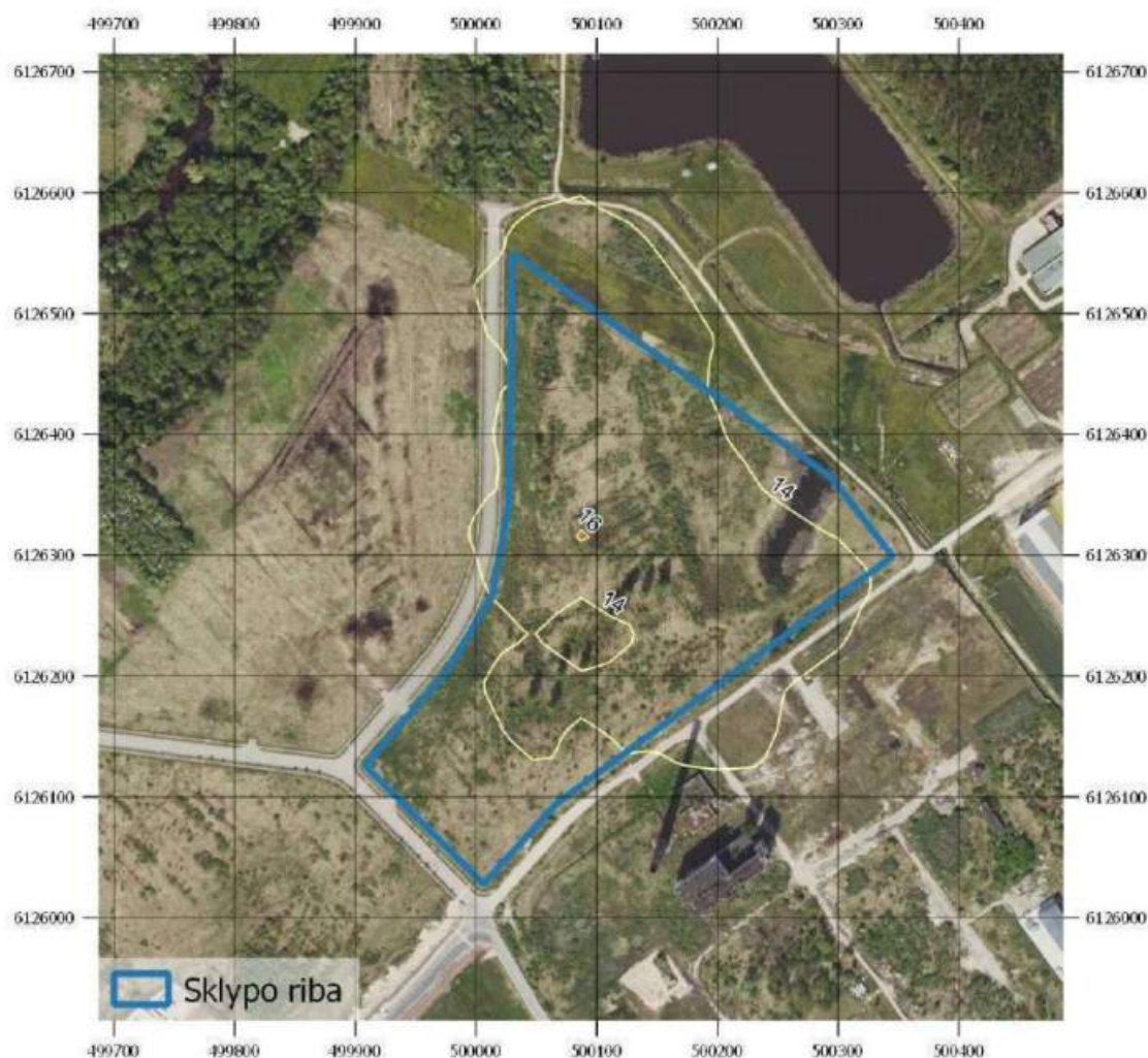
31 pav. Sumodeliuotų pažemio koncentracijų sklaidos žemėlapis (0,4 km spindulys). Kietųjų dalelių KD_{10} 24 valandų 90,4-o procentilio koncentracija ( \mu\text{g}/\text{m}^3 ).
