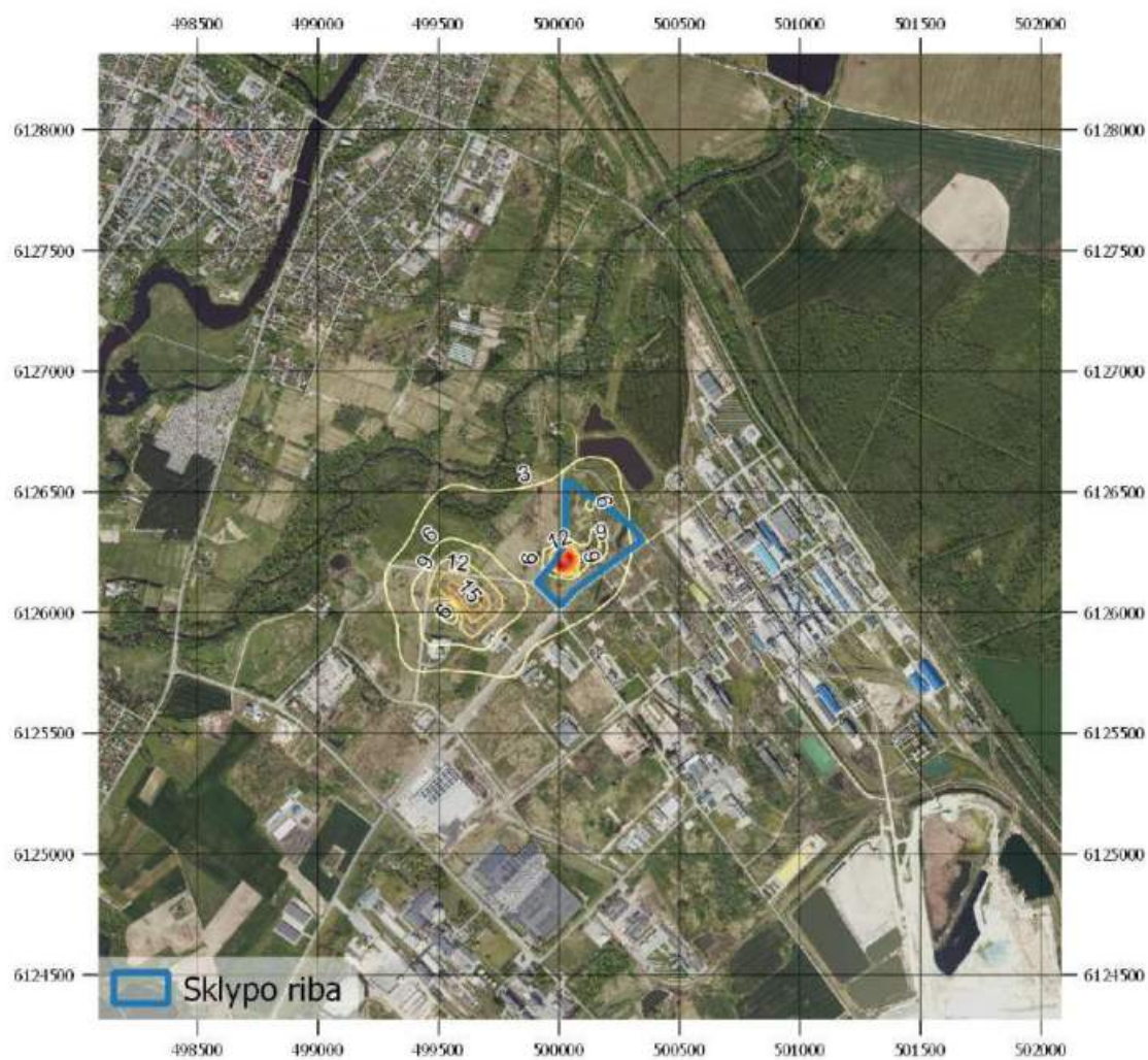
38 pav. Sumodeliuotų pažemio koncentracijų sklaidos žemėlapis (2,0 km spindulys). Lakiųjų organinių junginių valandos 98,5-o procentilio koncentracija ( \mu\text{g}/\text{m}^3 ).
