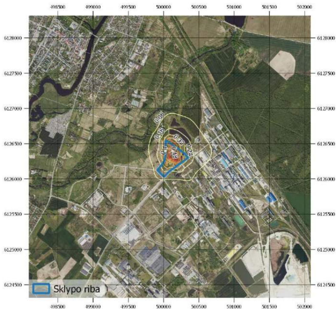
12 pav. Sumodeliuotų pažemio koncentracijų sklaidos žemėlapis (2,0 km spindulys). Kietųjų dalelių KD 2,5 metų vidutinė koncentracija (µg/m 3 ).
