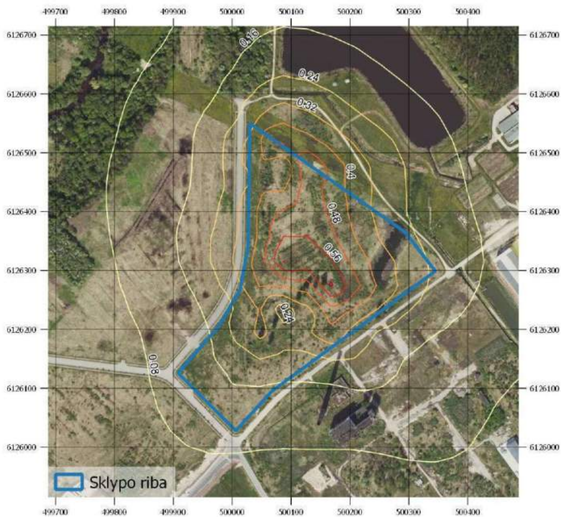
13 pav. Sumodeliuotų pažemio koncentracijų sklaidos žemėlapis (0,4 km spindulys). Kietųjų dalelių KD_{2,5} metų vidutinė koncentracija ( \mu\text{g}/\text{m}^3 ).
