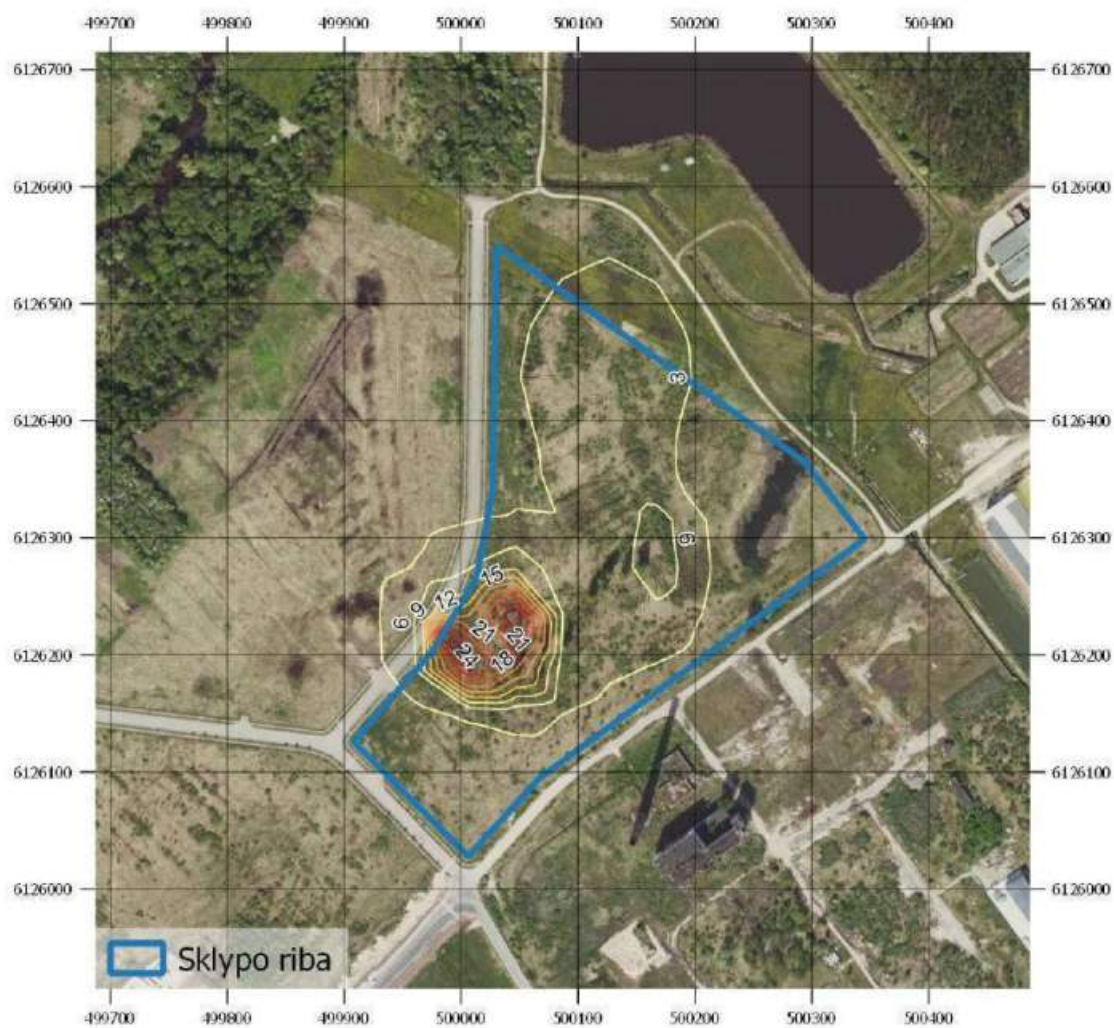
21 pav. Sumodeliuotų pažemio koncentracijų sklaidos žemėlapis (0,4 km spindulys). Lakiųjų organinių junginių valandos 98,5-o procentilio koncentracija ( \mu\text{g}/\text{m}^3 ).
