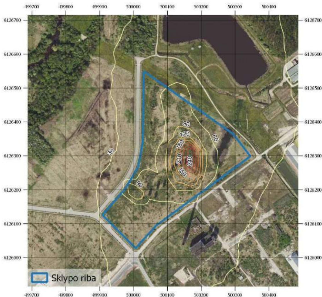
27 pav. Sumodeliuotų pažemio koncentracijų sklaidos žemėlapis (0,4 km spindulys). Azoto dioksido 1 valandos 99,8-o procentilio koncentracija ( \mu\text{g}/\text{m}^3 ).
