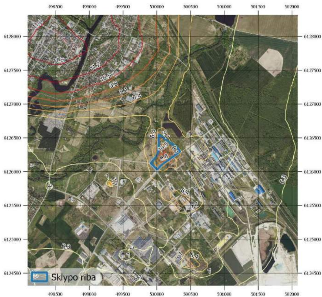
34 pav. Sumodeliuotų pažemio koncentracijų sklaidos žemėlapis (2,0 km spindulys). Kietųjų dalelių KD_{2,5} 24 valandų 99,2-o procentilio koncentracija ( \mu\text{g}/\text{m}^3 ).
