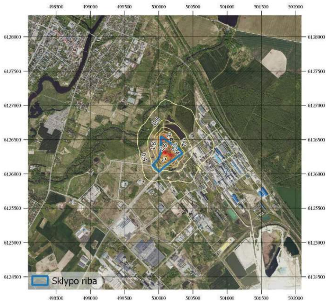
10 pav. Sumodeliuotų pažemio koncentracijų sklaidos žemėlapis (2,0 km spindulys). Kietųjų dalelių KD_{10} 24 valandų 90,4-o procentilio koncentracija ( \mu\text{g}/\text{m}^3 ).
