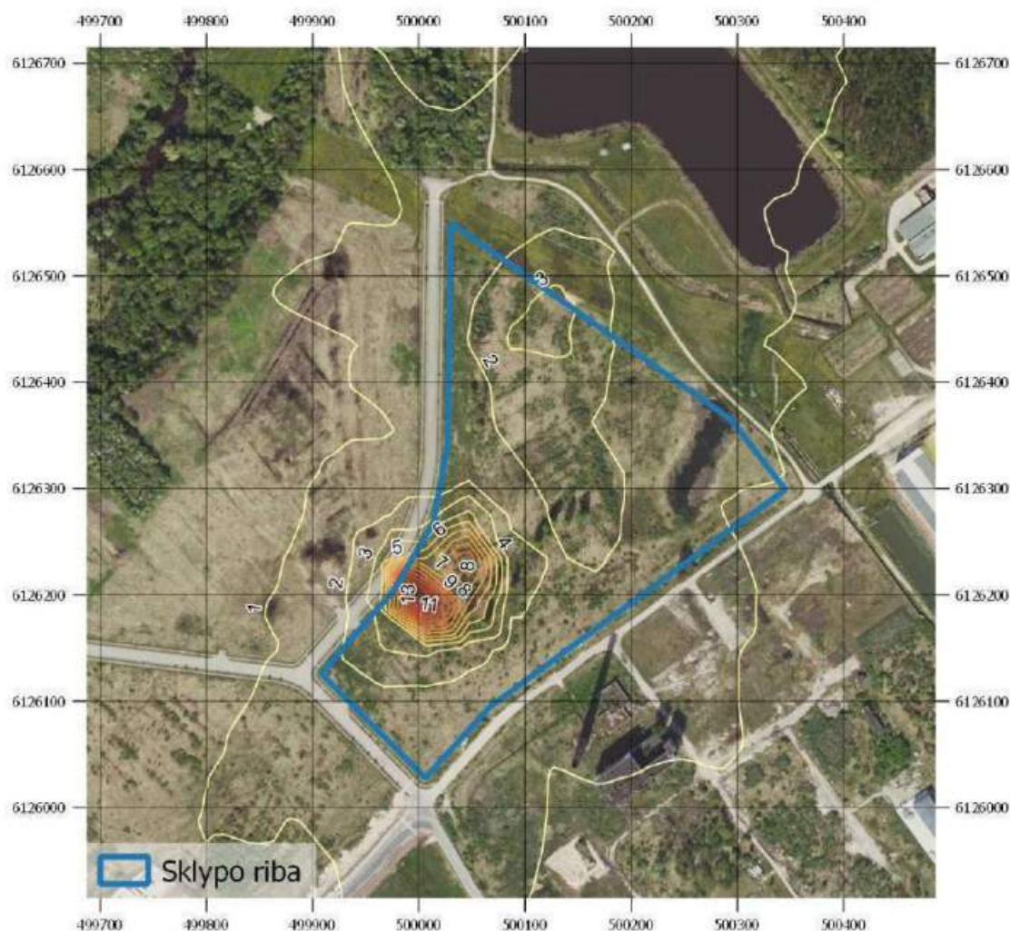
19 pav. Sumodeliuotų pažemio koncentracijų sklaidos žemėlapis (0,4 km spindulys). Lakiųjų organinių junginių 24 valandų vidurkio 100-ojo procentilio koncentracija ( \mu\text{g}/\text{m}^3 ).
