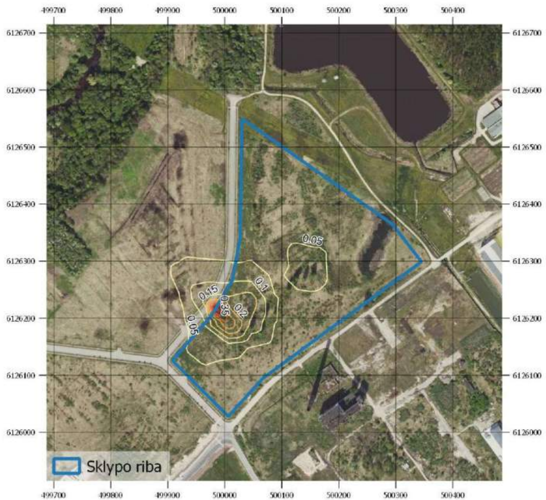
23 pav. Sumodeliuotų pažemio koncentracijų sklaidos žemėlapis (0,4 km spindulys). Anglies monoksido 8 valandų slenkančio vidurkio 100-ojo procentilio koncentracija ( \text{mg}/\text{m}^3 ).
