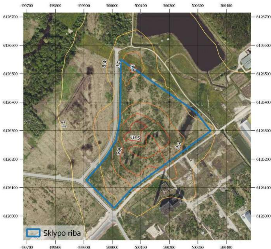
35 pav. Sumodeliuotų pažemio koncentracijų sklaidos žemėlapis (0,4 km spindulys). Kietųjų dalelių KD 2,5 24 valandų 99,2-o procentilio koncentracija ( \mu\text{g}/\text{m}^3 ).
