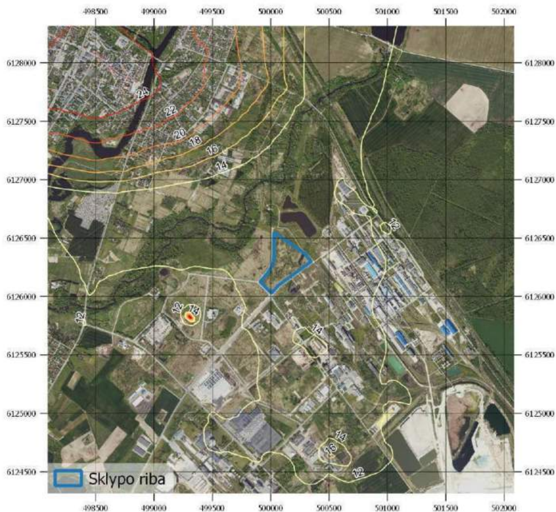
28 pav. Sumodeliuotų pažemio koncentracijų sklaidos žemėlapis (2,0 km spindulys). Kietųjų dalelių KD 10 metų vidutinė koncentracija (µg/m 3 ).
