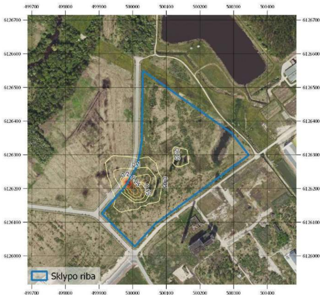
3 pav. Sumodeliuotų pažemio koncentracijų sklaidos žemėlapis (0,4 km spindulys). Anglies monoksido 8 valandų slenkančio vidurkio 100-ojo procentilio koncentracija ( \text{mg}/\text{m}^3 ).
