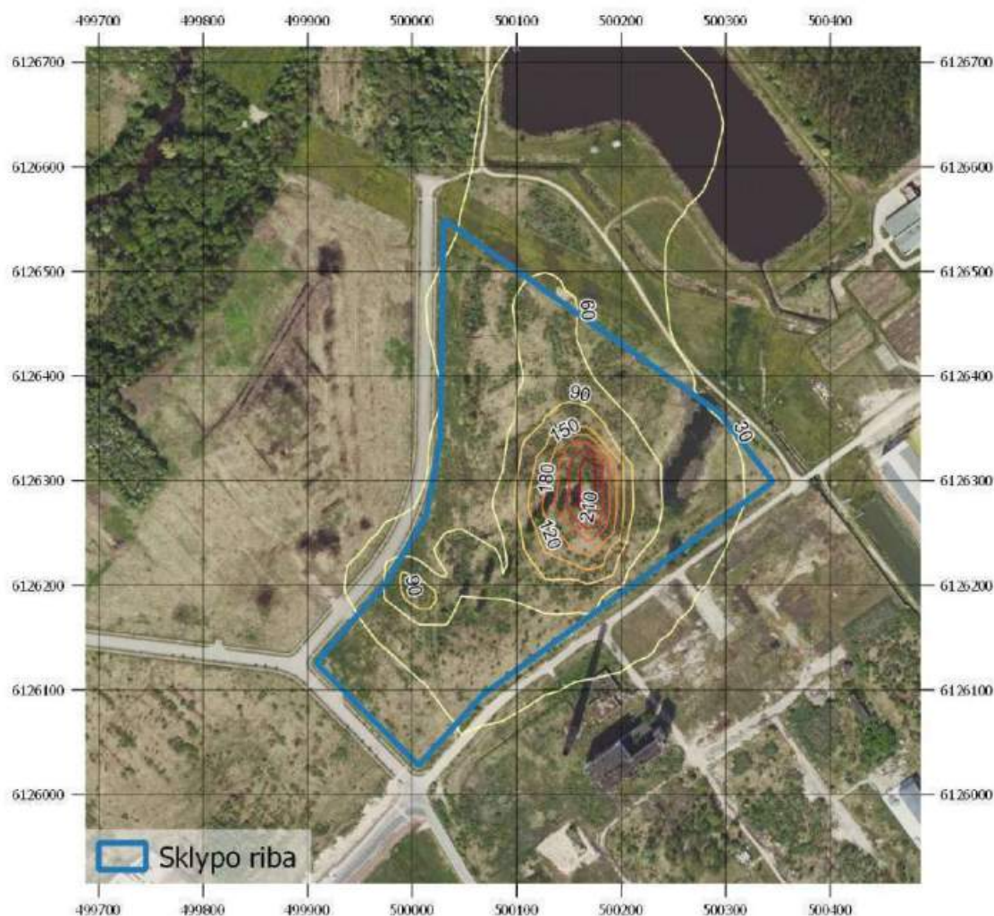
7 pav. Sumodeliuotų pažemio koncentracijų sklaidos žemėlapis (0,4 km spindulys). Azoto dioksido 1 valandos 99,8-o procentilio koncentracija ( \mu\text{g}/\text{m}^3 ).
