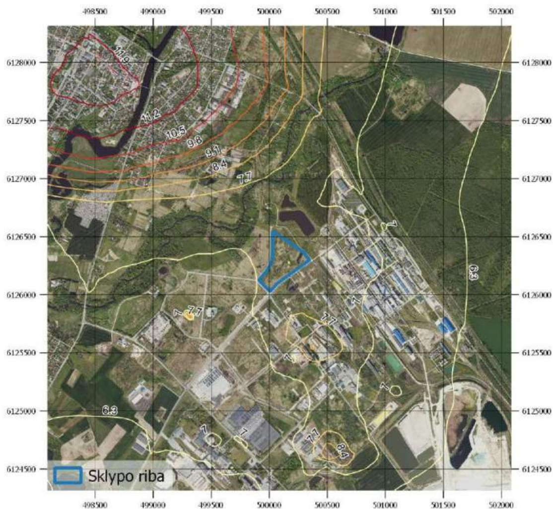
32 pav. Sumodeliuotų pažemio koncentracijų sklaidos žemėlapis (2,0 km spindulys). Kietųjų dalelių KD 2,5 metų vidutinė koncentracija (µg/m 3 ).
