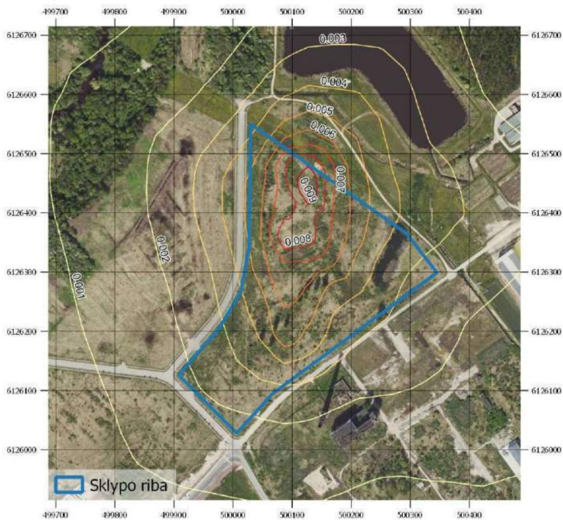
17 pav. Sumodeliuotų pažemio koncentracijų sklaidos žemėlapis (0,4 km spindulys). Kvapų valandos 98,08-o procentilio koncentracija (OUE/m 3 ).
