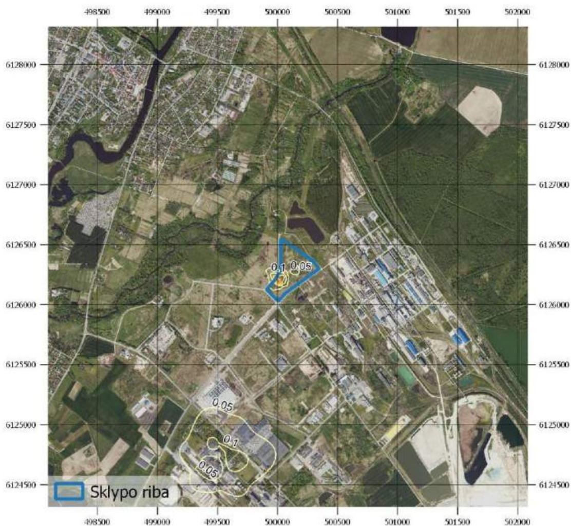
22 pav. Sumodeliuotų pažemio koncentracijų sklaidos žemėlapis (2,0 km spindulys). Anglies monoksido 8 valandų slenkančio vidurkio 100-ojo procentilio koncentracija (mg/m 3 ).
